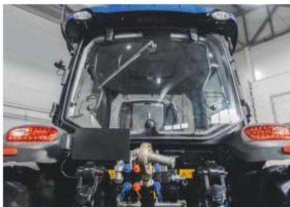
Трактор оснащен камерой заднего вида, проблесковым маячком и системой угольной фильтрации
