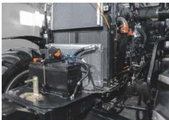
Трактор оснащен активным охлаждением трансмиссии
