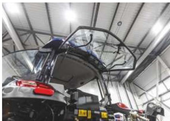
Заднее стекло кабины оснащено пневматическими амортизаторами
