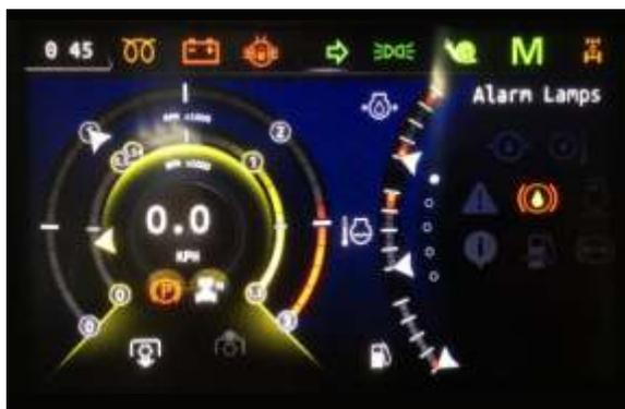
Многофункциональный ЖК-дисплей с функцией автодиагностики системы, может отображать код неисправности
