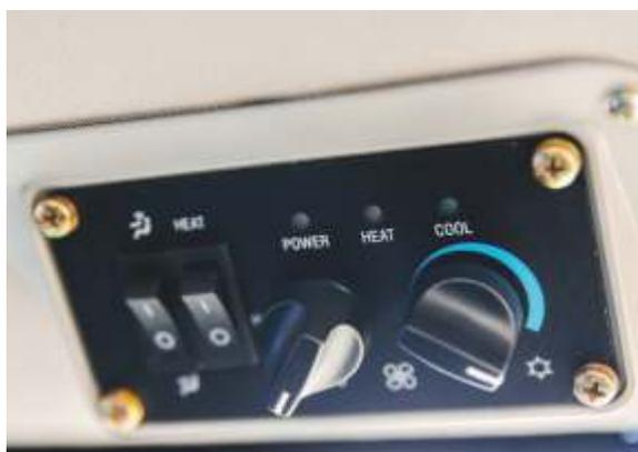
Трактор оснащен блоком контроля климата
